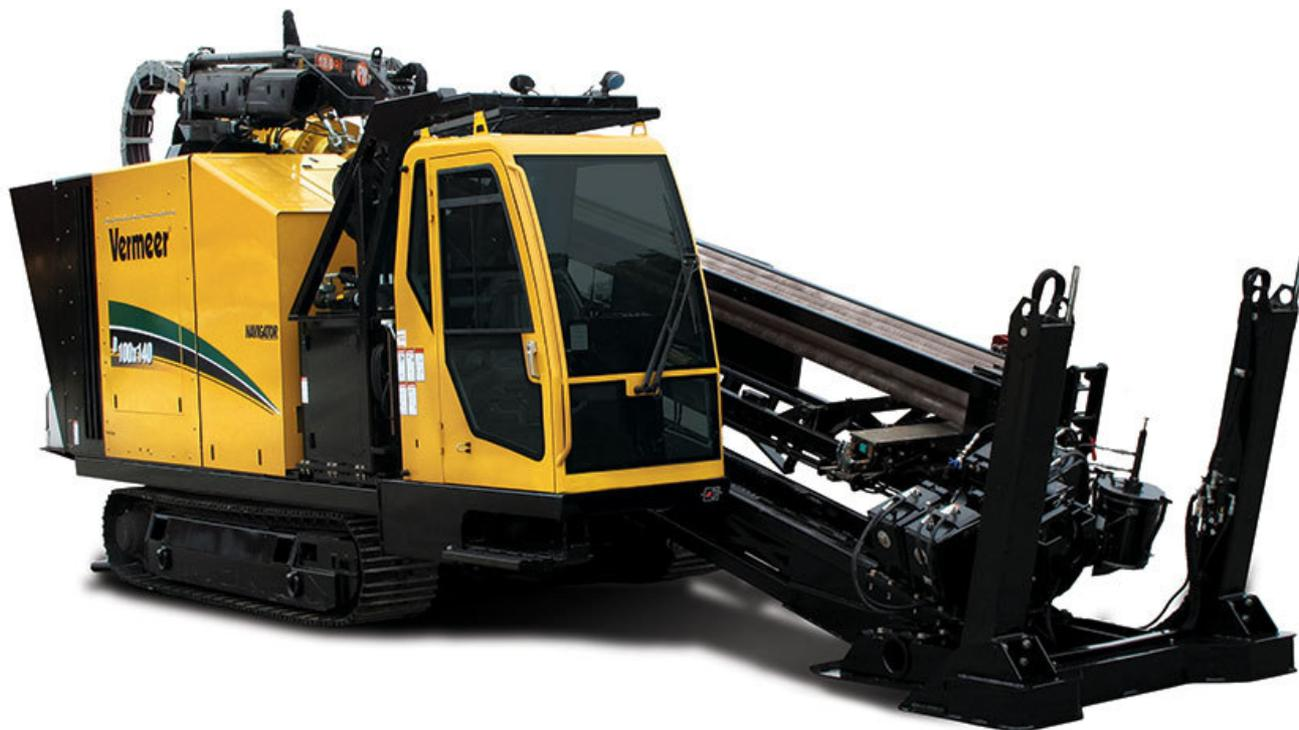
Niente è più importante della potenza di perforazione. Con una coppia di rotazione fino a 18,981.5 Nm e una velocità di rotazione fino a 203 rpm, il D100x140 S3 Navigator® è la risposta per i lavori più impegnativi.
